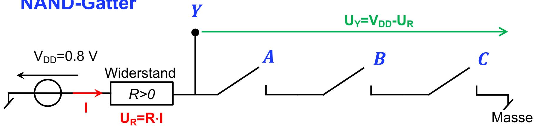
Wenn  $A=B=C=1$ , dann ist der Ausgang  $Y$  mit der Masse gebunden, i.e.  $Y=1$  und die angelegte Spannung  $V_{DD}=0.8 \text{ V}$  fällt über den Serie Widerstand  $R$ .
