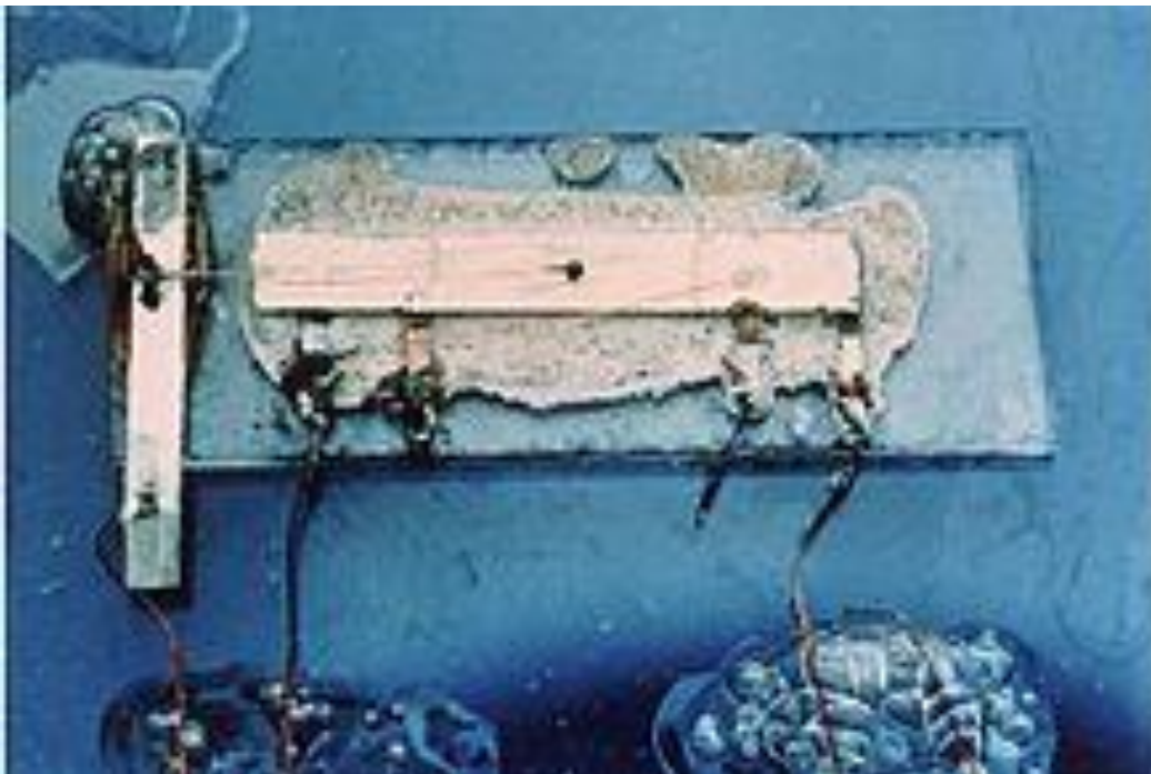
Jack Kilbys ursprüngliche integrierte Schaltung, die 1958 hergestellt wurde.
