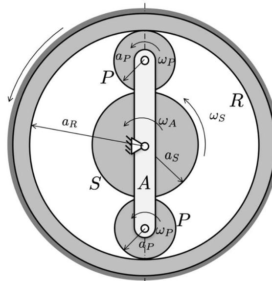
1. Was ist der Zusammenhang  $\frac{\omega_P}{\omega_S}$  zwischen den Winkelgeschwindigkeiten des Planeten- und Sonnenzahnrades?
