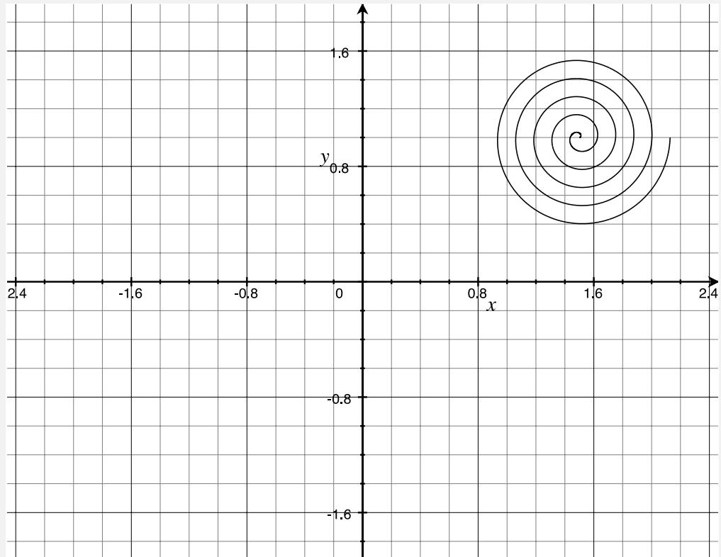
$$\begin{bmatrix} x(t) \\ y(t) \end{bmatrix} = \begin{bmatrix} 1.5 \\ 1 \end{bmatrix} + \frac{t}{50} \begin{bmatrix} \cos t \\ \sin t \end{bmatrix}$$
