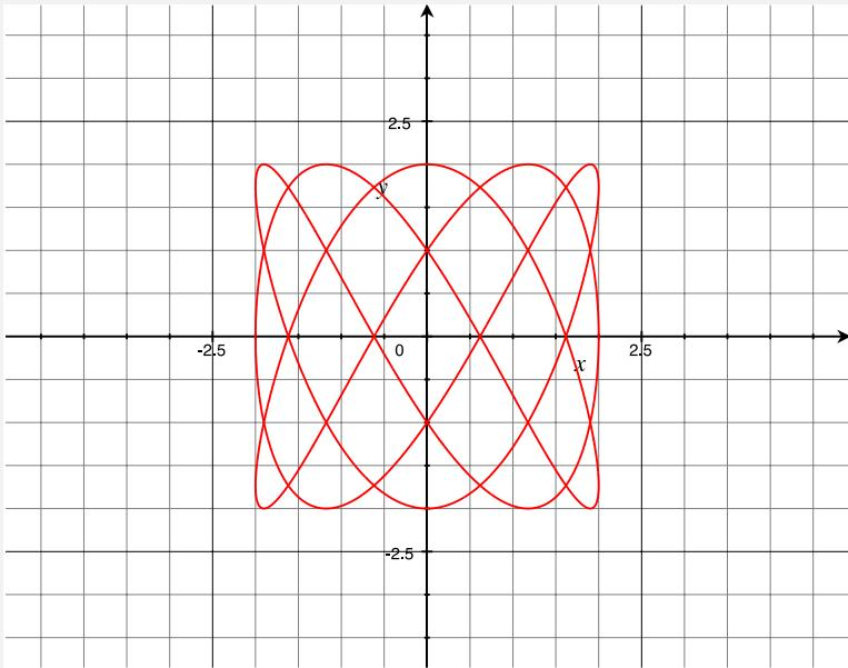
$$\begin{bmatrix} x(t) \\ y(t) \end{bmatrix} = 2 \begin{bmatrix} \cos 3t \\ \sin 5t \end{bmatrix} \quad 0 < t < 2\pi$$
